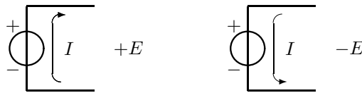
Kuva 2. Jännitelähteen etumerkin määrittäminen.
